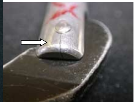
写真左：カラビナ全景 写真下：破損部の拡大
