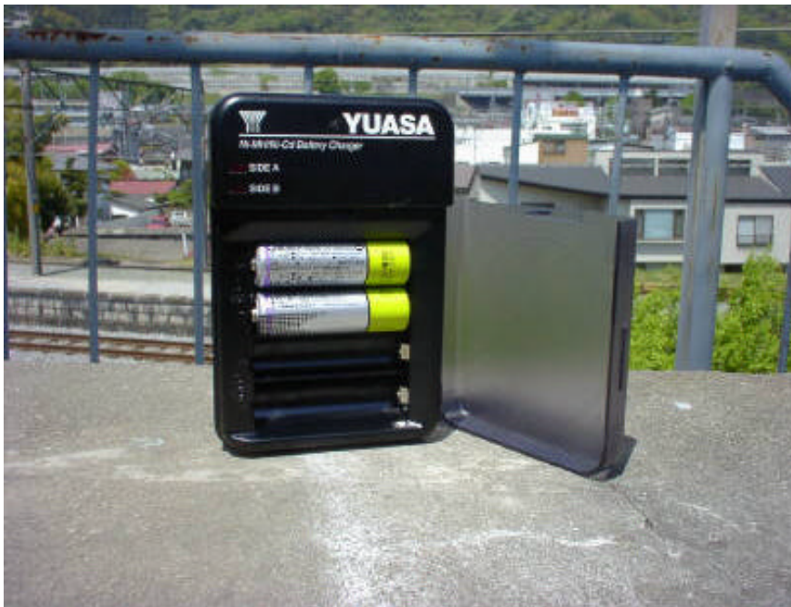
写真2 ニッケル・カドミウム / 水素電池の充電器
